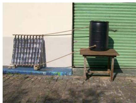
Figura 1: Aquecedor solar montado
