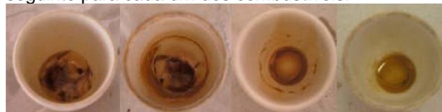
**Figura 2:** Fotos dos resíduos da queima total das amostras de biodiesel do posto de gasolina, diesel, biodiesel de etanol e biodiesel de metanol respectivamente da esquerda para direita.
